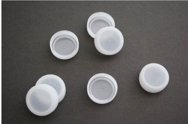
Abb. 2: 3 Mio. Verschlusskappen aus HDPE pro Tag – hergestellt auf der EcoPower Xpress
